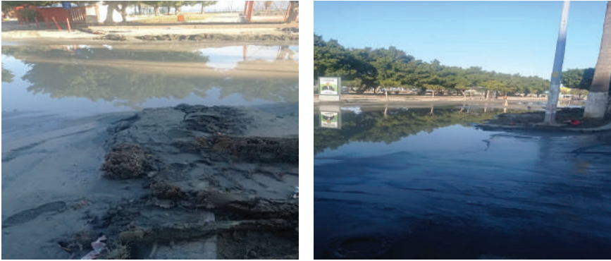
Şekil 33. Hatay-İskenderun ilçesinde sıvılaşma sonrası yeraltı suyu çıkışı
