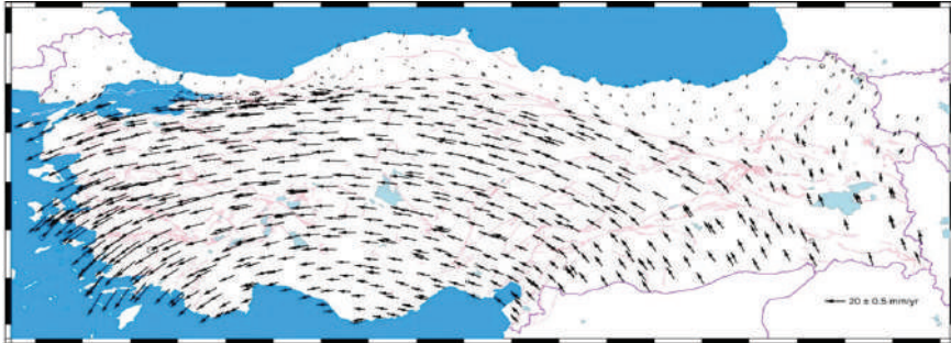
Şekil 4. TUREF noktalarında ITRF2014 hız alanı modeline göre tanımlanmış hızlar. Hız alanının arka planında açık kırmızı çizgiler Türkiye sınırları içerisindeki fayları göstermektedir (HGM, 2023).
