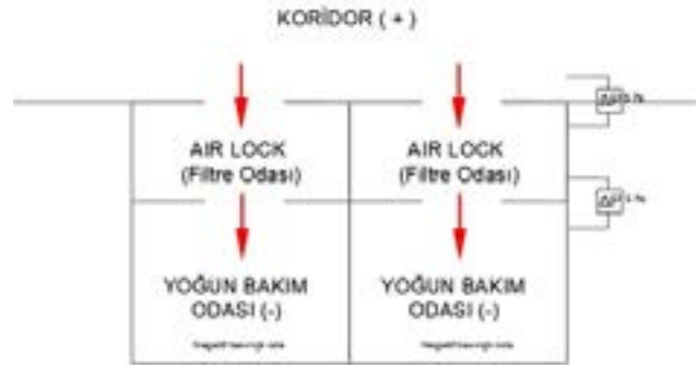
Şekil-2 – Pandemi döneminde çalıştırılacak negatif basınçlı yoğun bakım odası hava akışı
