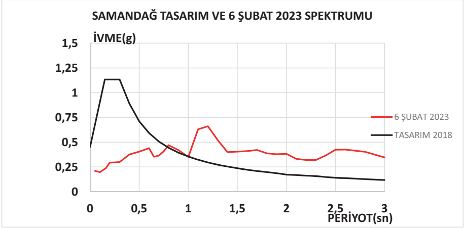
Şekil-6: Samandağ ivme kaydından hesaplanmış tepki spektrumu ve aynı nokta için Tasarım Spektrumu. (N. Bayülke)
