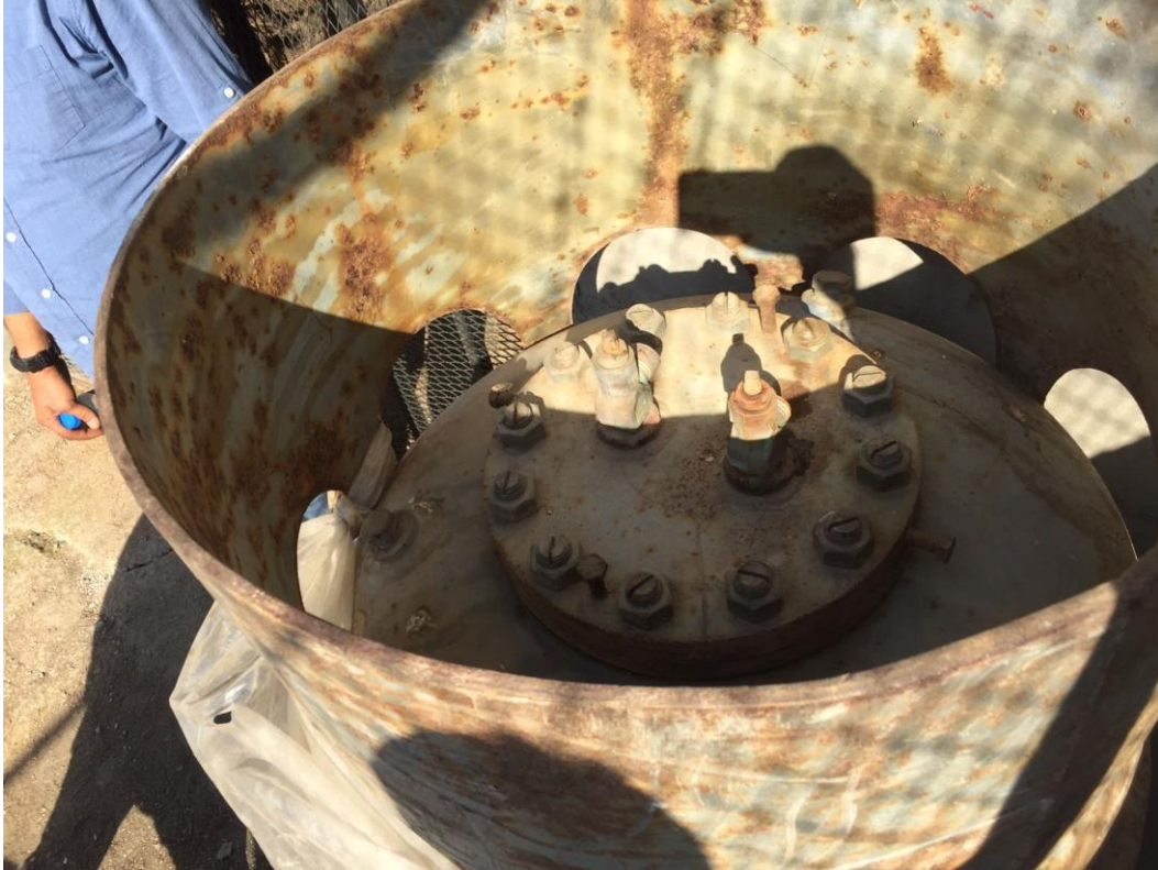
Fotoğraf 3 Kurtalan Belediyesi Makine İkmal ve Bakım Birimi deposu, boş olduğu ileri sürülen klor tankı vana bölümü
